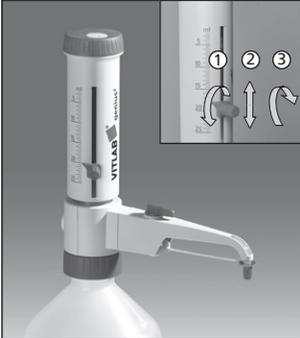
**Variabel:** Volumeneinstellschraube mit einer  $\frac{3}{4}$  Umdrehung lösen (1), den Anzeigepfeil vertikal bis zum gewünschten Volumen verschieben (2) und die Volumeneinstellschraube wieder festdrehen (3).
