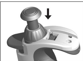
6. Justageschieber erneut vollständig nach hinten schieben, das Volumeneinstellrad nach unten drücken und den Justageschieber loslassen. Abdeckung wieder montieren.
